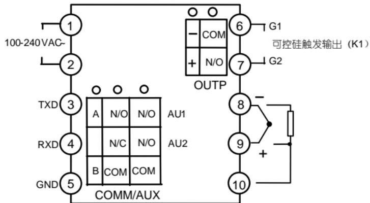
注1：D2面板尺寸仪表线不支持0~5V及1~5V线性电压输入，如有需要应外接精密电阻分压后将信号转换为0-500mV或100-500mV输入、4~20mA线性电流输入用25欧电阻变为100~500mV，然后从9、8端输入。
