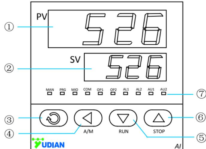
仪表上电后进入基本显示状态，此时仪表上、下显示窗分别显示测量值（PV）和给定值（SV），下显示窗还可交替显示以下字符表示状态：①“orAL”，表示输入的测量信号超出量程；②“HIAL”、“LoAL”、“HdAL”或“LdAL”时，分别表示发生了上限报警、下限报警、偏差上限报警、偏差下限报警；③“StoP”表示处于停止状态；“HoLd”和“rdy”分别表示暂停状态和准备状态（仅AI-526P程序型仪表使用）。
