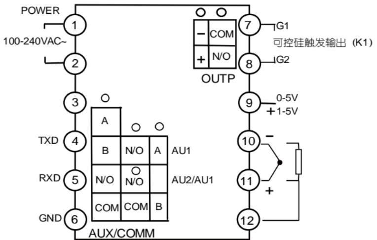
注1：D6面板尺寸仪表0-5V/1-5V从9+、10-输入，500MV以下从11+、10-输入，4-20mA线性电流输入用250欧姆电阻变为1-5V，然后从9+、10-输入。
