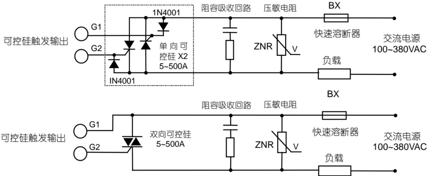
注1：根据负载的电压及电流大小选择压敏电阻以保护可控硅，负载为感性或采用移相触发时必须加阻容吸收。
